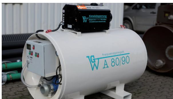
FIGURA 1. Sistema de reducción de aguas subterráneas GWA 80/90 con una bomba de vacío de rotores de uña Mink MV 0080 C de Busch con controlador de frecuencia
