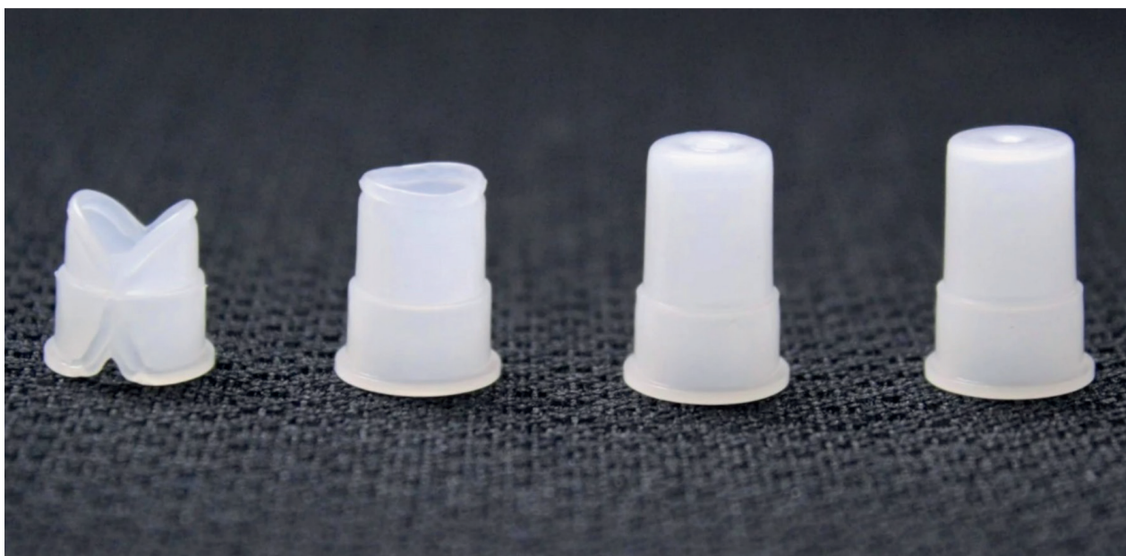
FIGURA 1. Solución de problemas de llenado y de líneas de unión ajustando la fluencia
