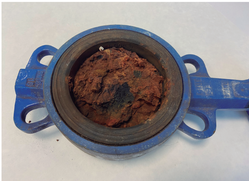
FIGURA 9. Fase 2: Inmersión en cuba con eliminador de óxido bioquímico para acero
