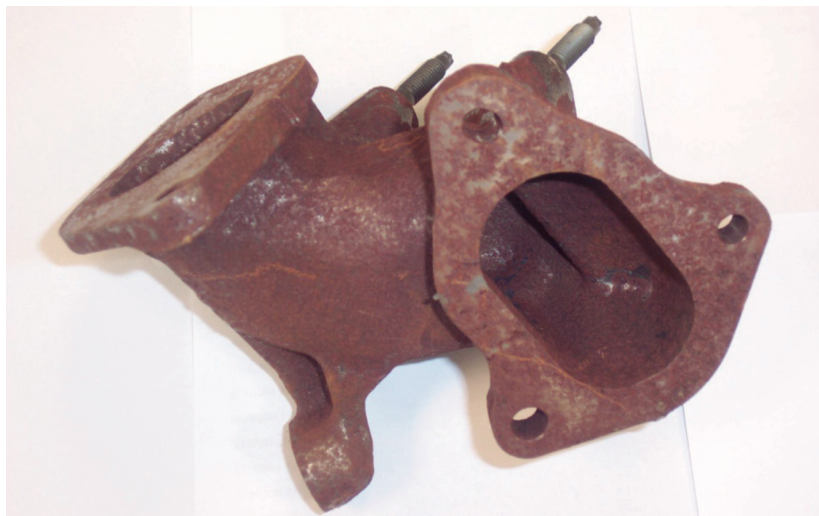
FIGURA 3. Colectores de escape antes y después del tratamiento con un eliminador de óxido bioquímico líquido
