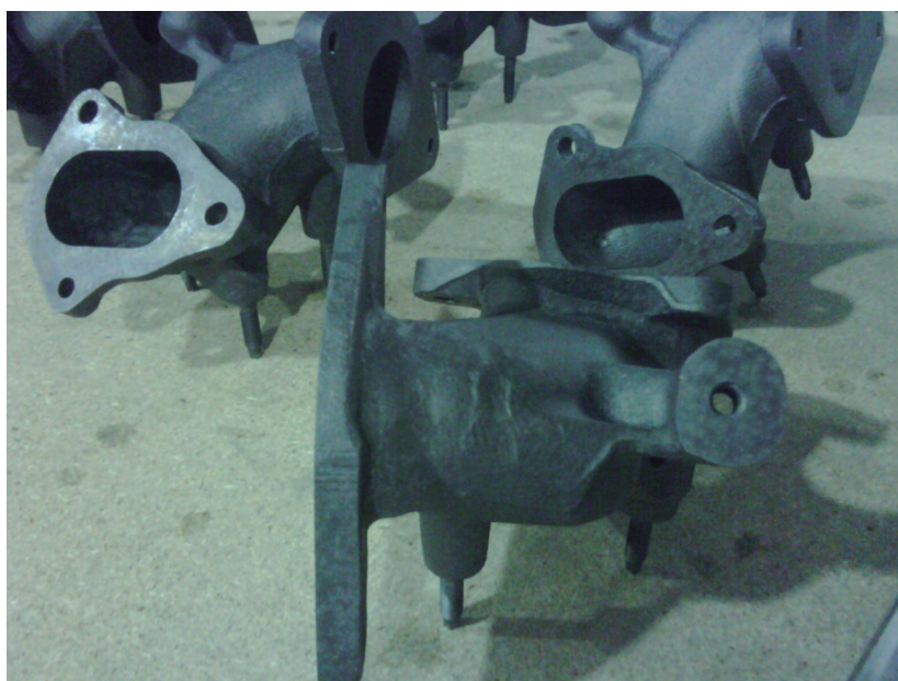
FIGURA 4. Colectores de escape antes y después del tratamiento con un eliminador de óxido bioquímico líquido
