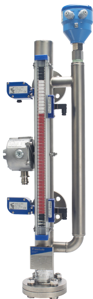
Construcción en AISI 316L, con distintos automatismos y cámara lateral con transmisor LTDR 4-20 mA
