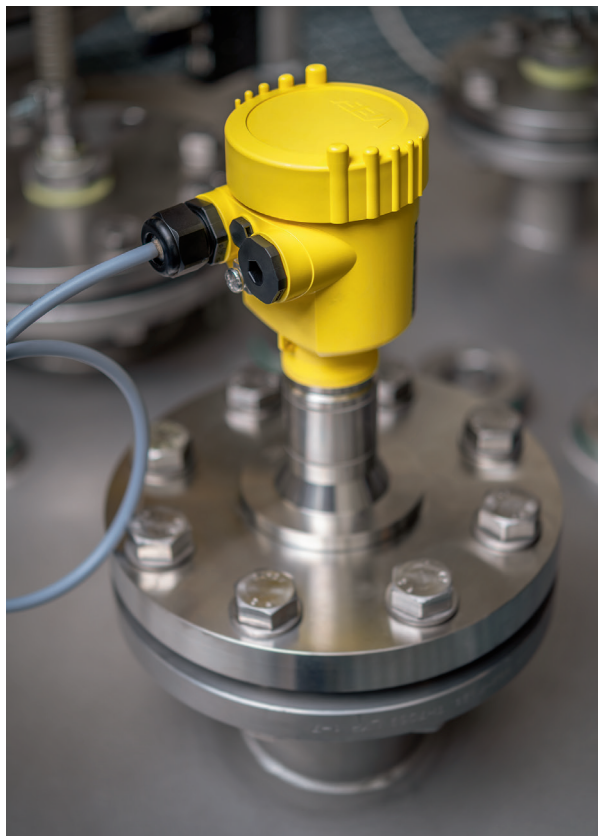
El concepto de seguridad del VEGAPULS 6X es una oferta integral: seguridad funcional (SIL), un sistema de autodiagnóstico y un desarrollo según la última norma de seguridad de TI IEC 62443-4-2, para una protección eficaz contra los ciberataques
