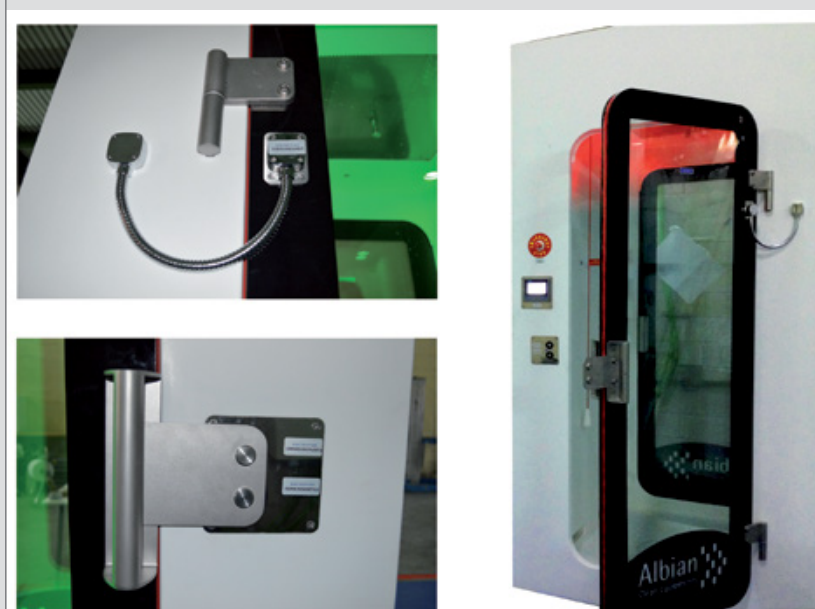
Foto 3. Puertas de junta hinchable para garantizar la contención
