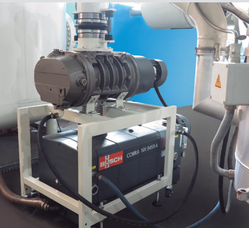
Bomba de vacío de tornillo COBRA NX como bomba primaria en un sistema de vacío de tres etapas. La bomba de vacío booster está montada directamente sobre la COBRA NX por medio de una brida de conexión
